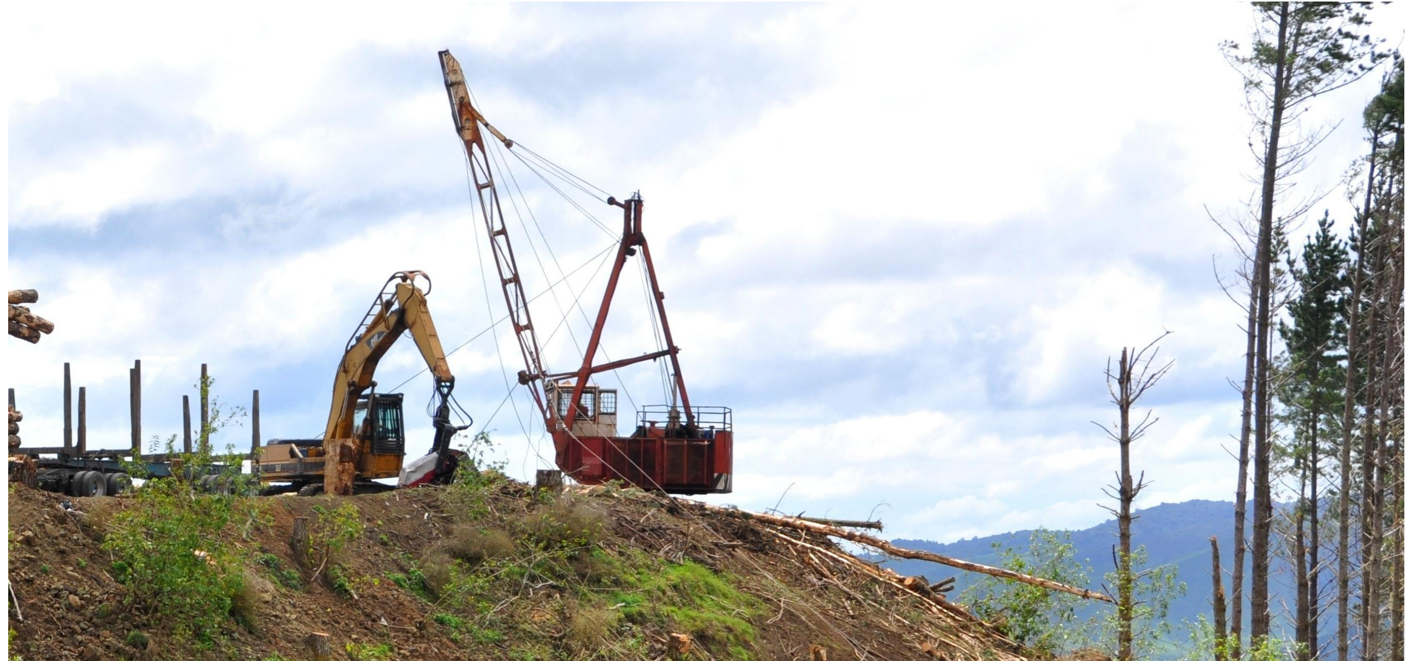
圖片: 曼加卡希亞採伐 - 原木採伐後會由纜線拉到暫時儲存地點
